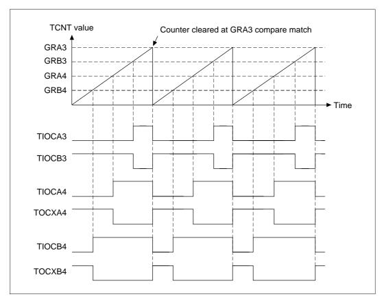
Figure 10.32 Reset-Synchronized PWM Mode Operation Example 1
